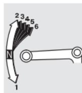
Cada toque no pedal muda para a marcha seguinte, em sequência. O pedal retorna automaticamente para a posição horizontal quando solto.
