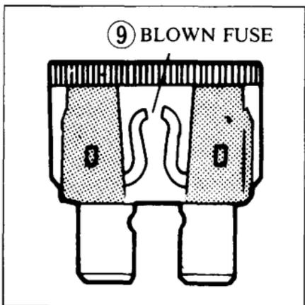
Zum Auswechseln von Sicherungen im Sicherungskasten (4) die Schrauben (5) herausdrehen und den Sicherungskastendeckel (6) abnehmen. Die alte Sicherung mit Hilfe der Sicherungszange (7) aus den Klemmen herausziehen. Eine neue Sicherung in die Klemmen schieben und den Sicherungskastendeckel installieren. Die Ersatzsicherungen (8) befinden sich im Sicherungskasten.
