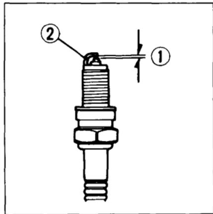
6. Vérifier les électrodes et la partie en porcelaine, susceptibles d'être couvertes de dépôts, de calamine, ou érodées. Remplacer la bougie lorsque celle-ci est trop érodée ou encrassée. Utiliser une brosse bougie pour le nettoyage ou une brosse en fil de fer.
